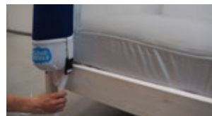
Foto 19: bevestig banden en trek op spanning.
