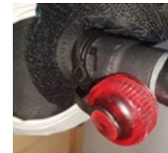
Foto 16: slang met koppelstuk bevestigd aan ventiel.
