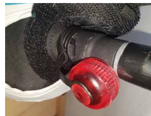
Foto 16: Slang met koppelstuk bevestigd aan ventiel.
