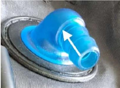
1. Schieben Sie den Schlauch so weit wie möglich über das Ventil – bis zum hochstehenden Rand – siehe Pfeil. (ggf. mit Seifenwasser, dann gleitet es leichter).
