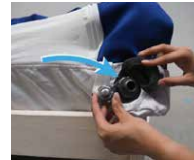
Foto 25: Hintere Ventilcappe öffnen und Luft ablassen.
