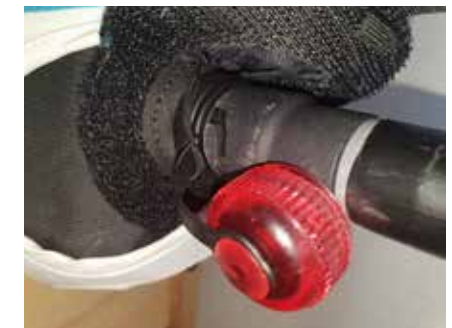
Foto 19: Schlauch mit Anschluss am Ventil befestigt.
