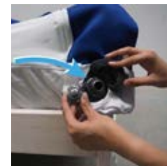
Foto 22: open achterste ventieldop en laat lucht ontsnappen.
