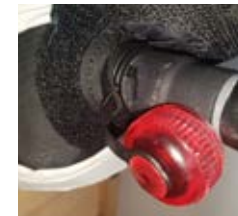
Foto 16: slang met koppelstuk bevestigd aan ventiel.
